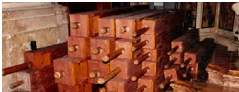
Le 27 canne di legno a forma di parallelepipedo del registro del contrabbasso
