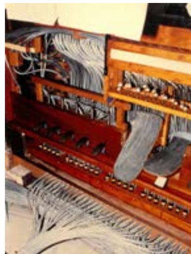
Interno della consolle con un fascio di tubicini che trasportano l'aria dai tre mantici alla tastiera.
